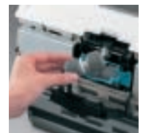
Benutzer kann Zufuhrrollen selbst auswechseln
